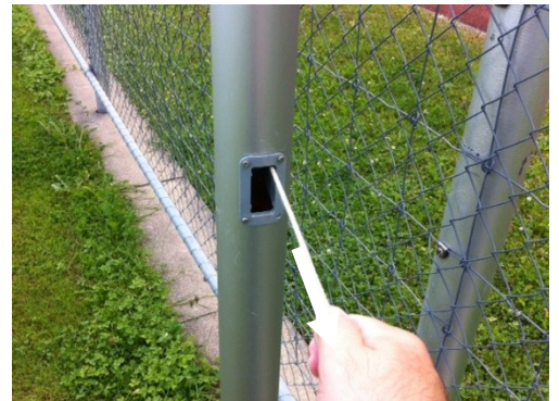
3. Schnur senkrecht aus dem Mast ziehen. Mast fährt hoch.
